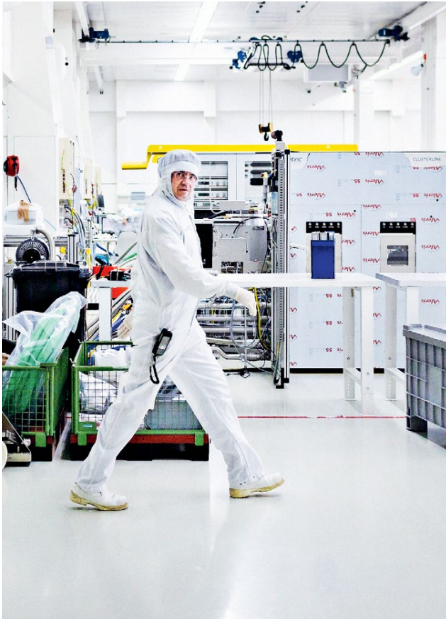
Links: Einblick in die Reinraummontage (Reinraumklasse ISO 7).
