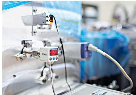
Unten: Prozess- und Drucküberwachung an einer Beschichtungsanlage.
